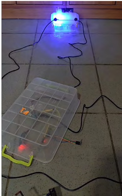
Рис. 4.3. Розроблена модульна система зволоження повітря
