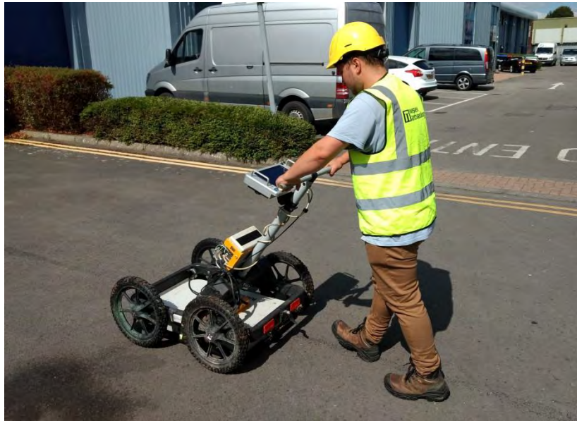
Рисунок 1.8. Застосування GPR спеціалістом на об'єкті
