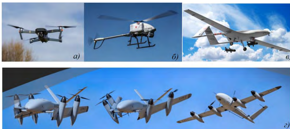
Рис.1.2 а) - Мультироторний дрон; б) - Однороторний дрон; в) - Дрон з фіксованим крилом; г) - Гібридний дрон.
