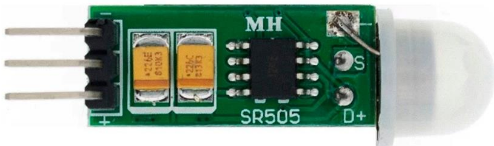
Рисунок 3.8. Модуль інфрачервоного датчик руху HC-SR505 міні [14]
