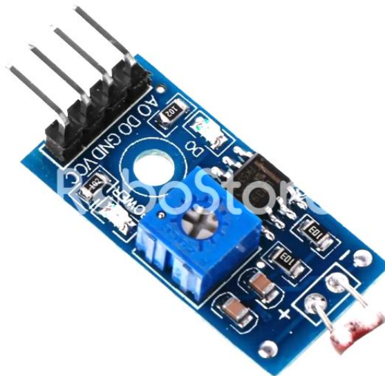
Рисунок 3.6. Модуль з фоторезистором аналого-цифровий [14]
