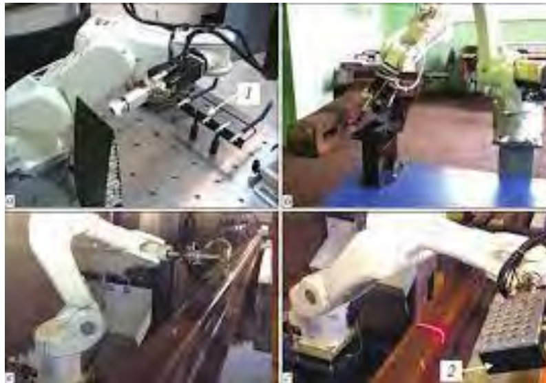
Рис.1.1. Роботизована система неруйнівного вихрострумового контролю виробів
