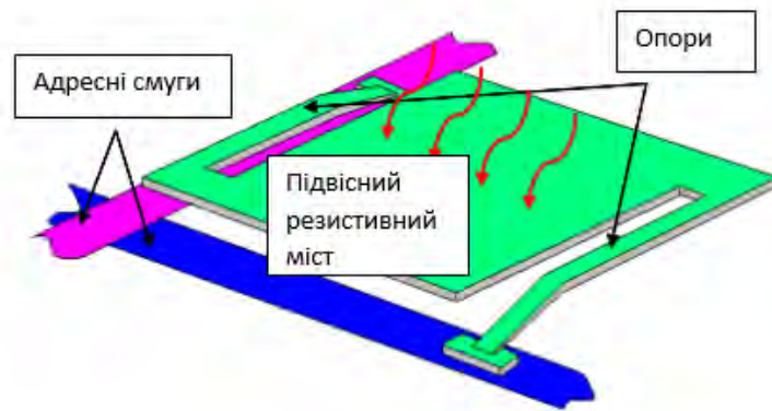
Рис. 1.13. Мікроболометр, 1 піксель матричного мікроболометричного FPA
