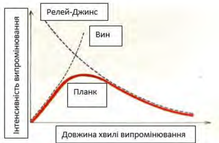
Рис. 1.4 Графік інтенсивності теплового випромінювання, побудований з використанням формули Планка.
