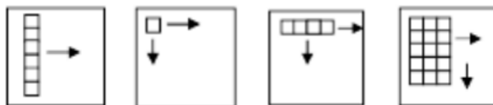
Рис. 1.10. - Методи сканування. Паралельне сканування, послідовне одноелементне, послідовне лінійне, паралельно послідовне матричним ПВ.
