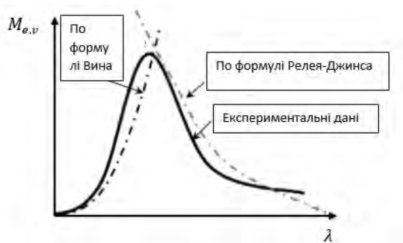
Рис. 1.3. Графіки, що показують залежність потужності випромінювання від довжини хвилі, розраховані експериментально, та за допомогою формул Релея-Джинса і Вина.
