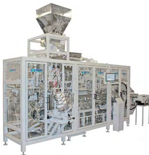
Рисунок 1.1 – Лінія автоматичного фасування борошна
