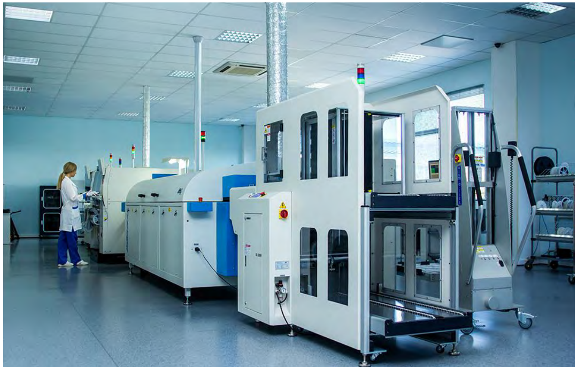
Рис. 1.3 – Автоматична лінія поверхневого монтажу друкованих плат
