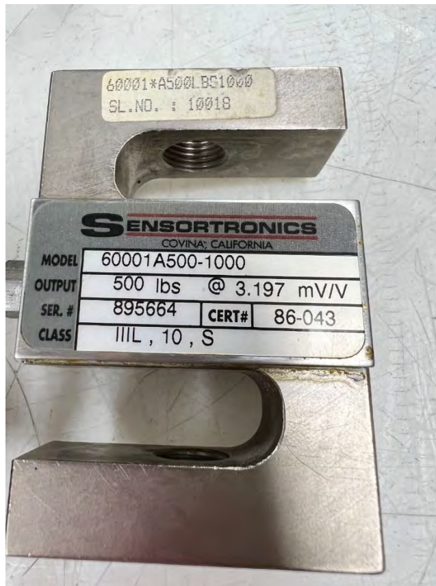
Рис. 3.3 – Тензорезисторний датчик типу 60001С
