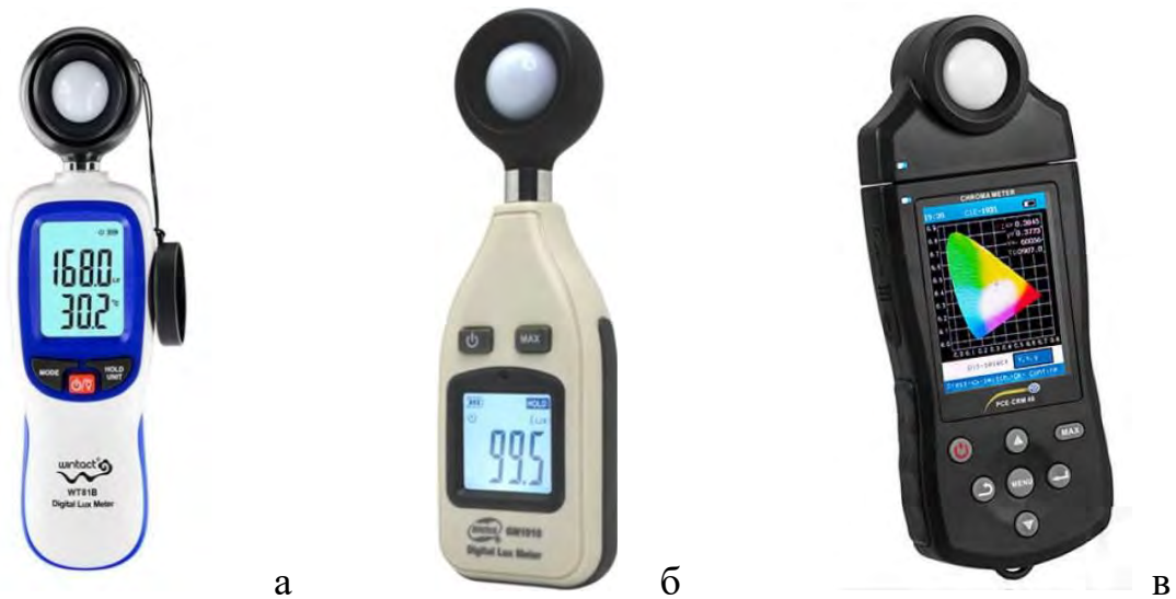
Рис. 11. а) 200000 Lux WINTACT WT81B, б) Люксметр Venetech GM1010, в) PCE-CRM 40 спектрометр, люксметр, колориметр
