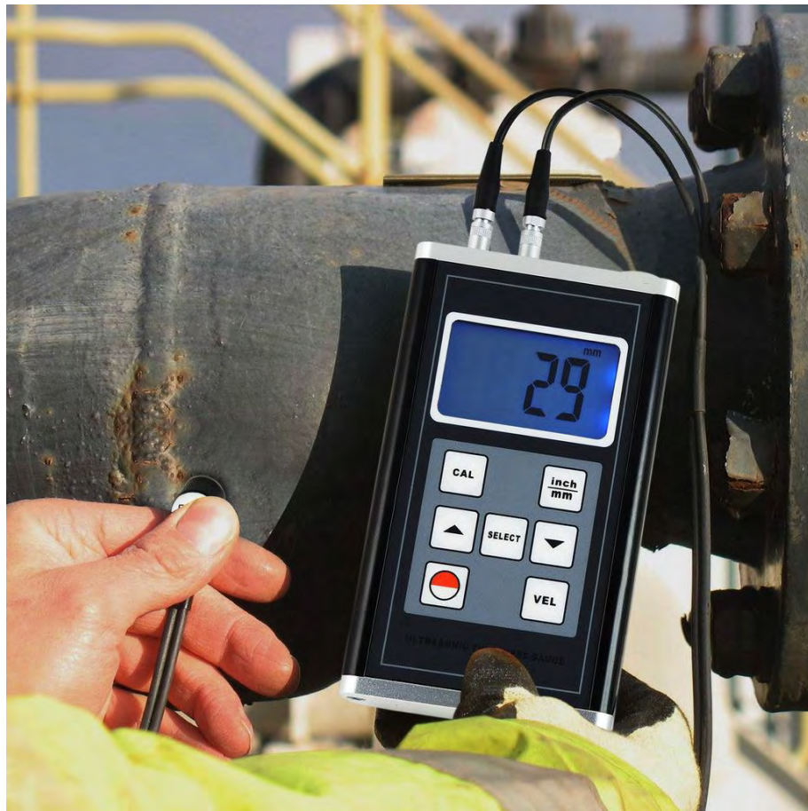
Рис. 1.4 Вимірювання товщини сталевих газових труб
