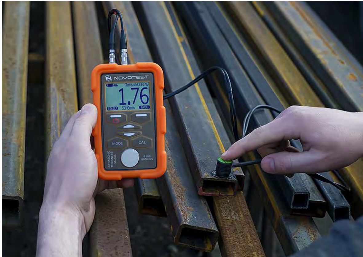
Рис. 1.5 Товщиномір УТ-1М вимірює товщину сталюї профільної труби
