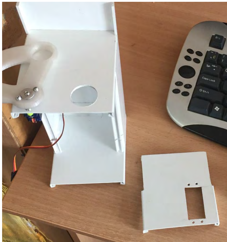
Рис. 31 Розміщення верхнього сервомотору та кріплення нижнього сервомотору
