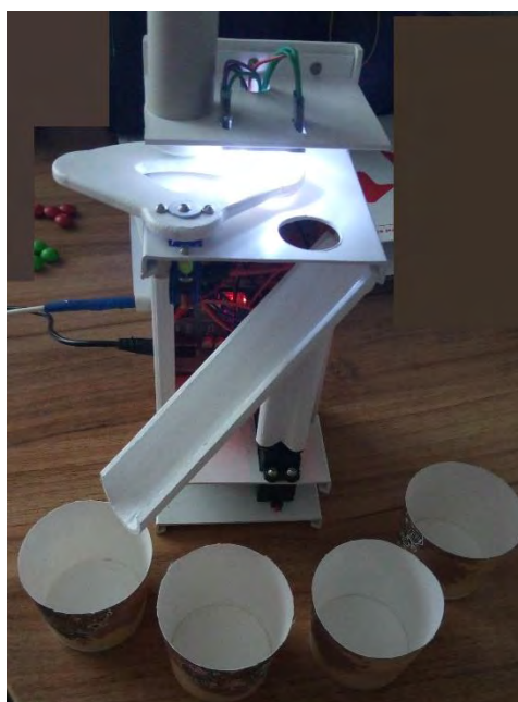
Рис. 38 Об'єкт потрапляє в пристрій та підноситься до датчика
