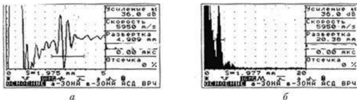
Рисунок 1.7. Сигнал, відбитий від сусіднього до поверхні отвору в зразку СО-2. Прямий ПЕП 10 МГц (а - режим радіосигналу, розгортка 5 мм, б - режим повного детектора, розгортка 20 мм)
