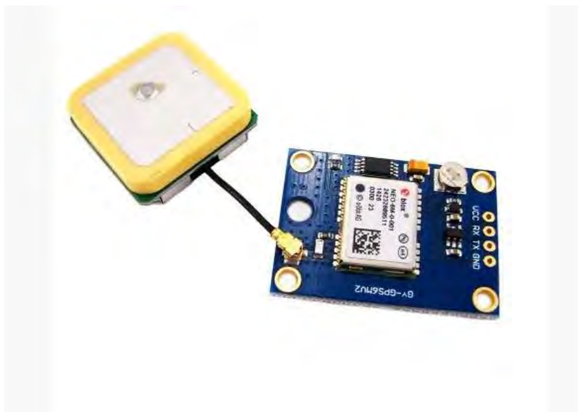
Рис.4.4.1. Ublox NEO-6M GPS-модуль з антеною
