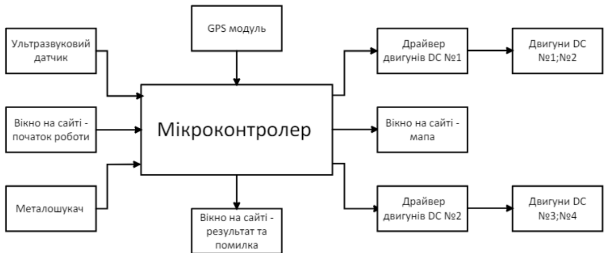
Рис.2.1. Структурна схема автоматизованої системи розмінування
