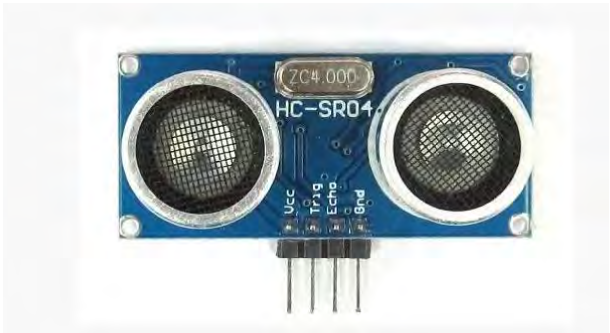
Рис 4.5.1. Ультразвуковий датчик HC-SR04
