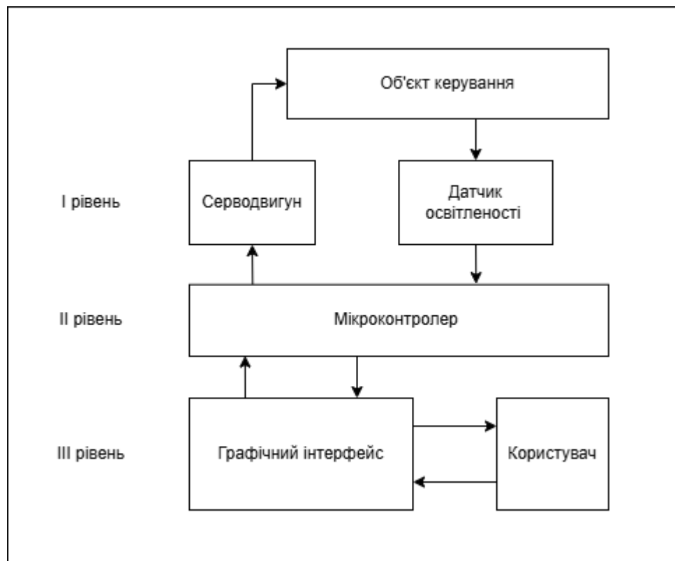
Рис. 2.1. Структурна схема системи автоматичного керування орієнтацією сонячних панелей
