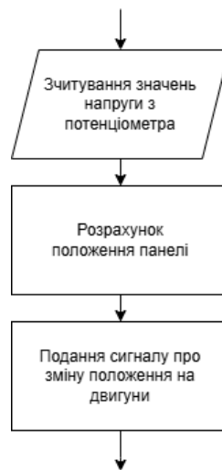
Рис. 3.4. Модуль алгоритму з отриманням значень від потенціометрів
