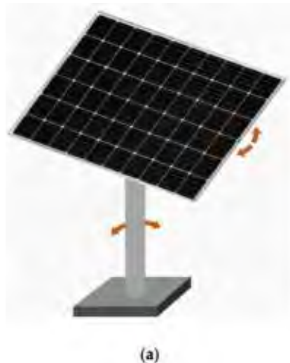
Рис. 1.6. Двовісний трекер з можливістю нахилу і повороту
