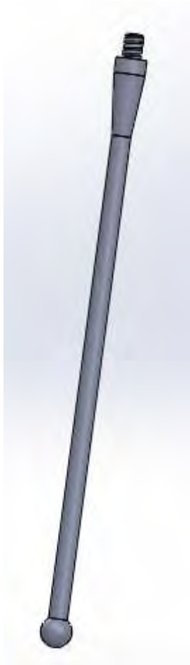
Рисунок 2.2 – 3Д модель вимірювального щупа
