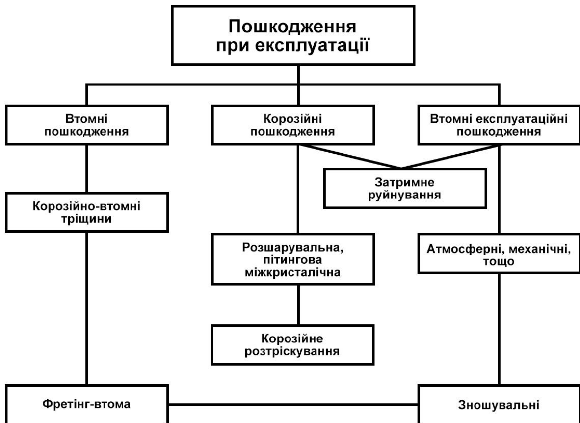
Рис. 1.21 Пошкодження конструкції в експлуатації
