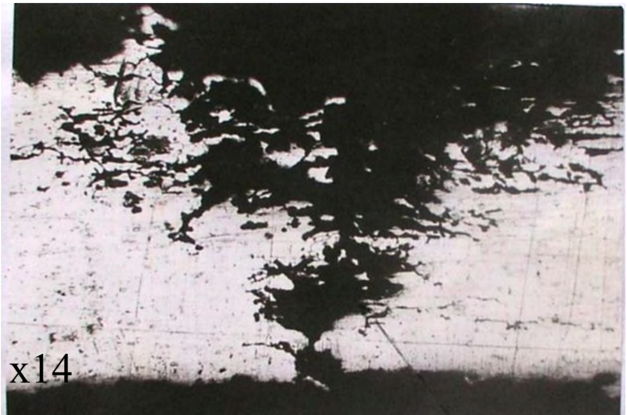
Рис. 1.26 Пітингове корозійне ураження в отворі обшивки фюзеляжу (без захисту за допомогою анодування), яке перебігло у міжкристалітну корозію.
