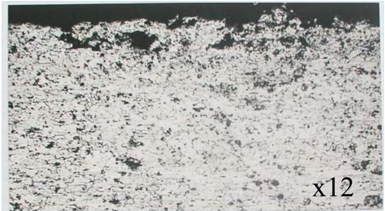
Рис. 1.25 Виразкова (пітингова) корозія обшивки фюзеляжу ПС
