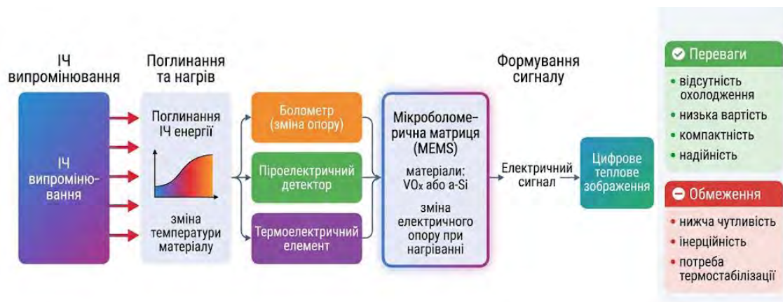
Рисунок 1.10. Принцип роботи теплових детекторів інфрачервоного випромінювання
