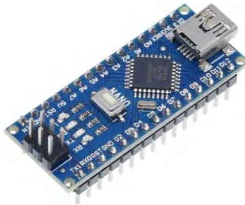
Рисунок 2.10. Arduino Nano на базі ATmega328P
