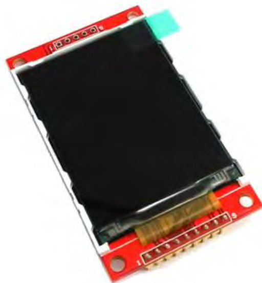
Рисунок 2.9. TFT LCD модуль на контролері ILI9341
