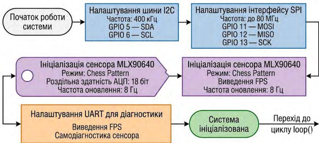
Рисунок 3.3 Алгоритм ініціалізації апаратних інтерфейсів та сенсора тепловізора
