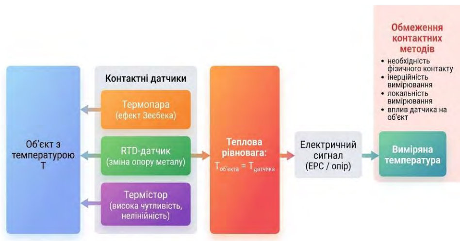
Рисунок 1.5. Контактні методи вимірювання температури та їх класифікація
