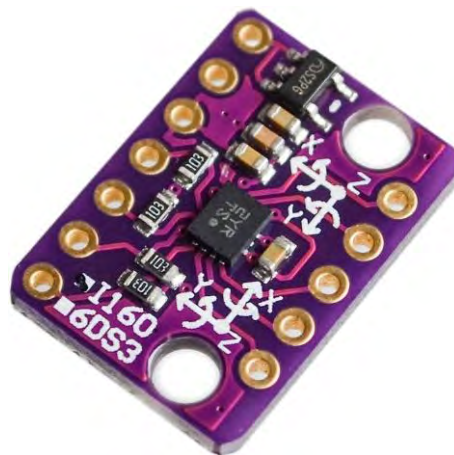
Рисунок 3.2. Модуль ІВМ на основі мікросхеми BM160
