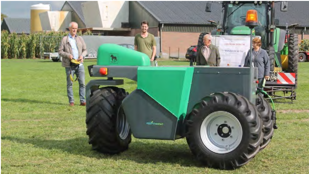
Рис. 3.3 Триколісна конструкція робота з одним поворотним колесом
