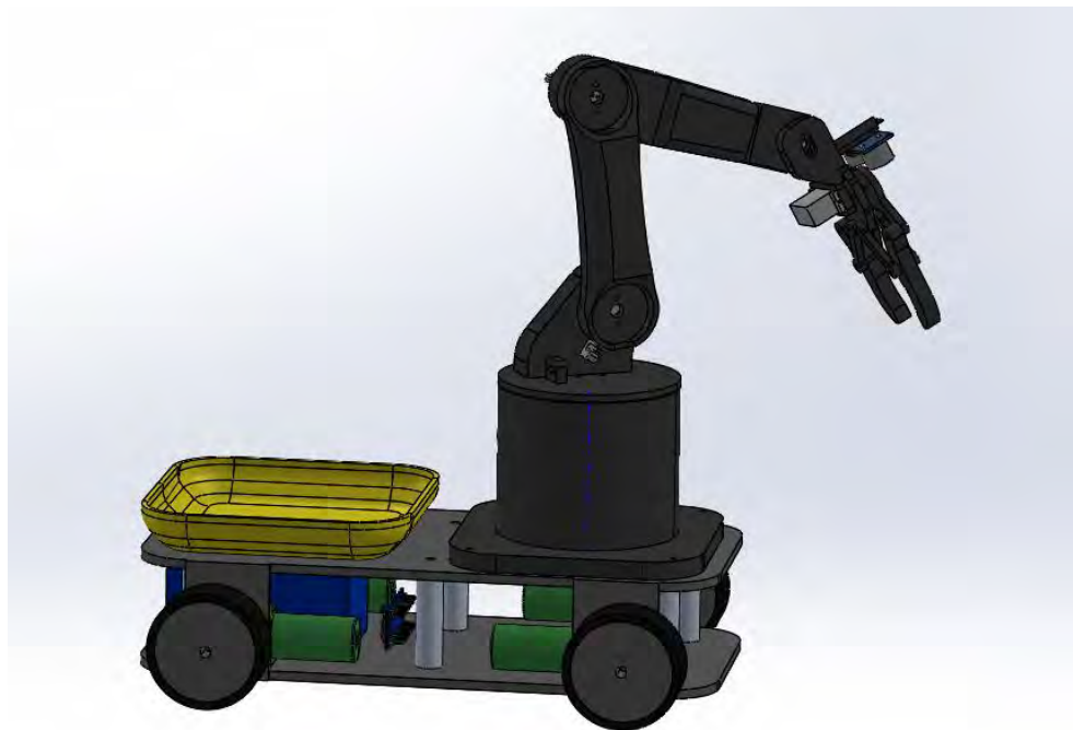
Рис. 3.6 – Тривимірна модель мобільного робота з маніпулятором у середовищі SolidWorks
