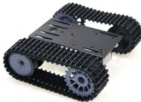
Рис. 3.4 Приклад гусеничного шасі для складних умов експлуатації
