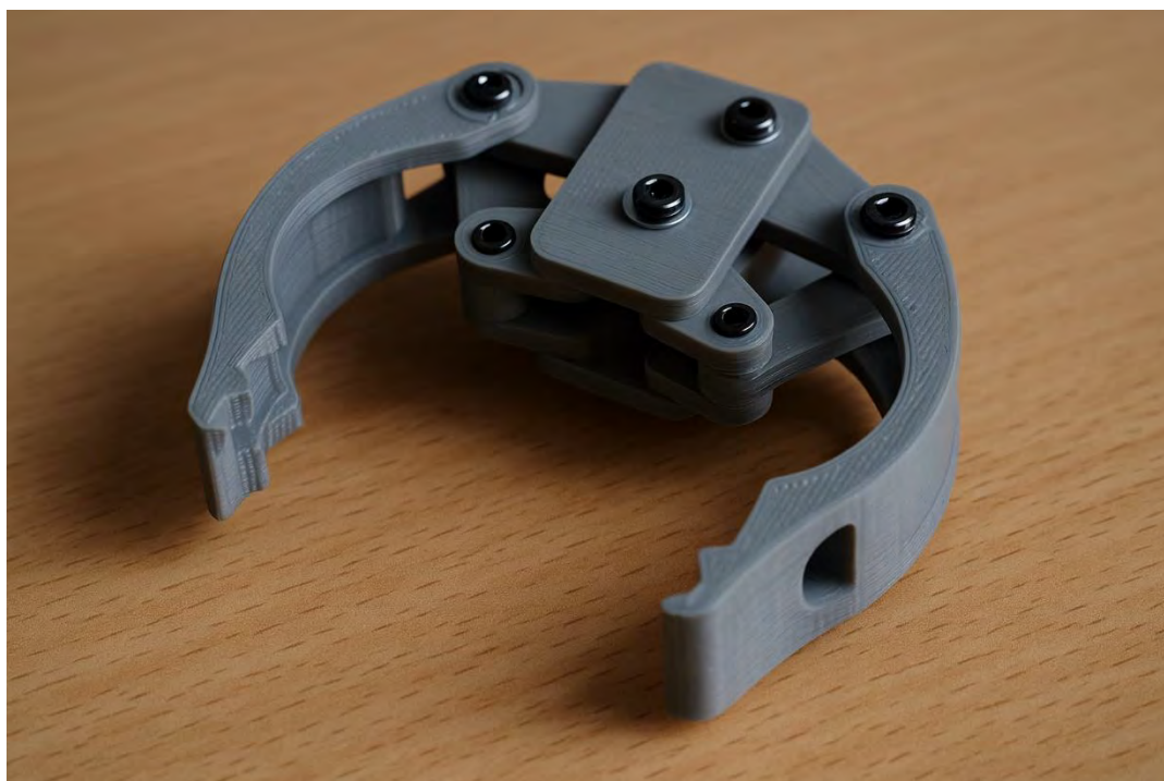
Рис. 2.10 – Модель механічної клешні, надрукованої на 3D-принтері
