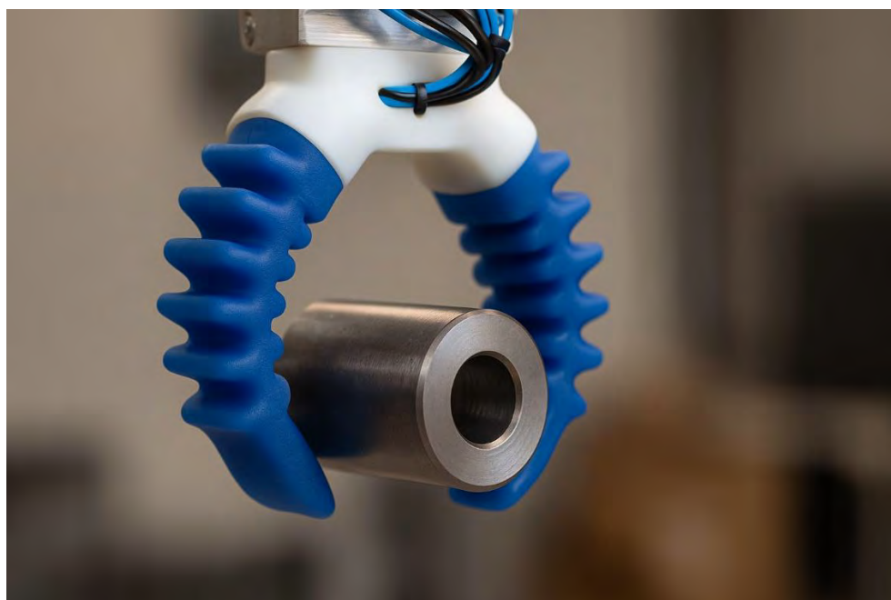
Рис. 2.9 – Гнучкий полімерний захоплювач (біоміметичний)
