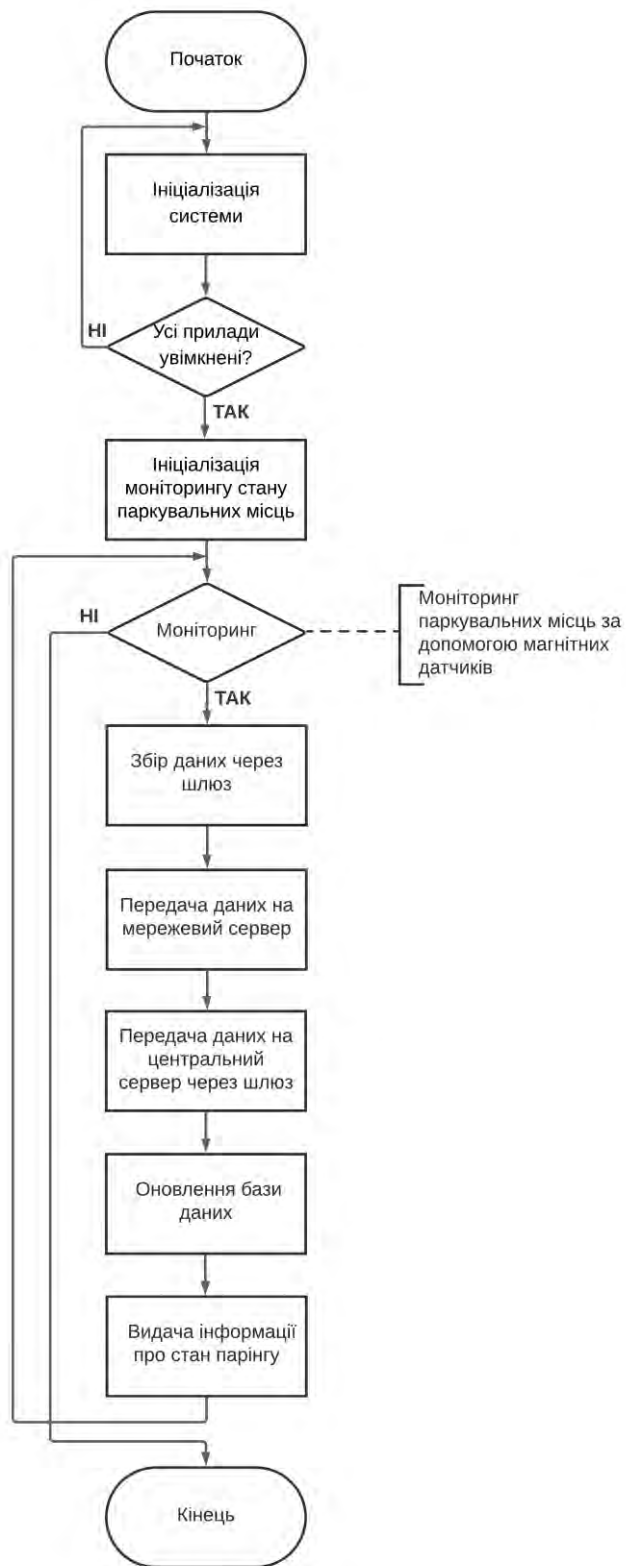
Рис. 2.3. Блок-схема алгоритму безперервного контролю стану паркувальних місць та видачі інформації про стан паркінгу
