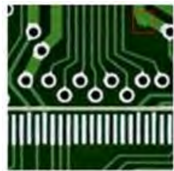
Рис.1.5. Дефект друкованої плати шпора
