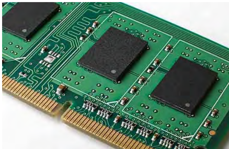
Рис 1.1. SMD – поверхневий монтаж
