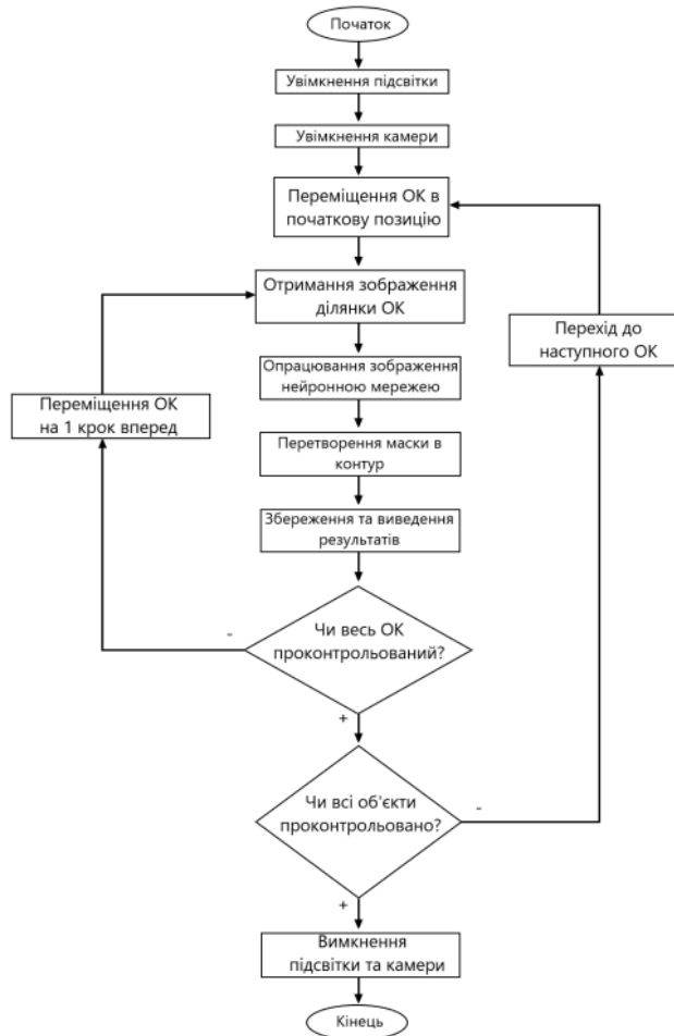
Рис 2.9. Алгоритм роботи приладу
