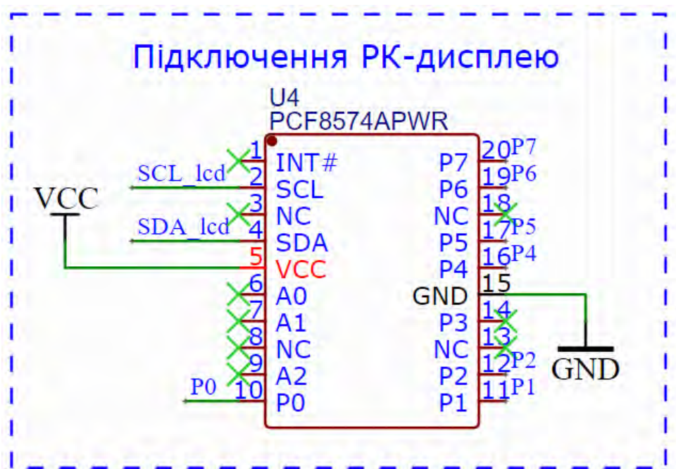
Рис. 3.16. Підключення перехідника РК-дисплею
