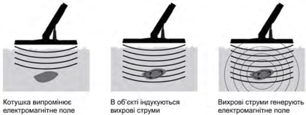
Рис. 1.1. Принцип роботи електромагнітного виявлення об'єкта
