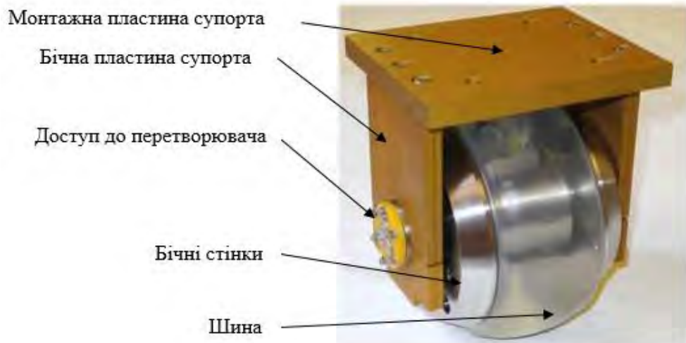
Рис. 13. Частини каткового перетворювача
