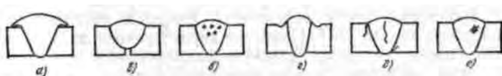
Рис. 1.4. Види дефектів у зварних з'єднаннях: а – наплив, б - непровар, в – пори, г – підрізи, д - тріщини, е – включення
