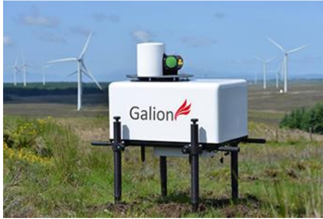
Рис. 2.8. Приклад наземного використання системи стеження LiDAR [17]
