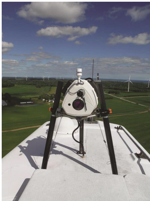
Рис. 2.7. Система стеження LiDAR розташована на вершині гондоли ВЕУ [16]
