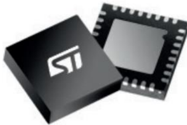
Рис. 1.9. Загальний вид мікроконтролера виконаного в корпусі UFQFPN48
