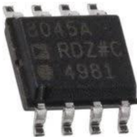
Рис. 2.2 Загальний вид підсилювача AD8045.
