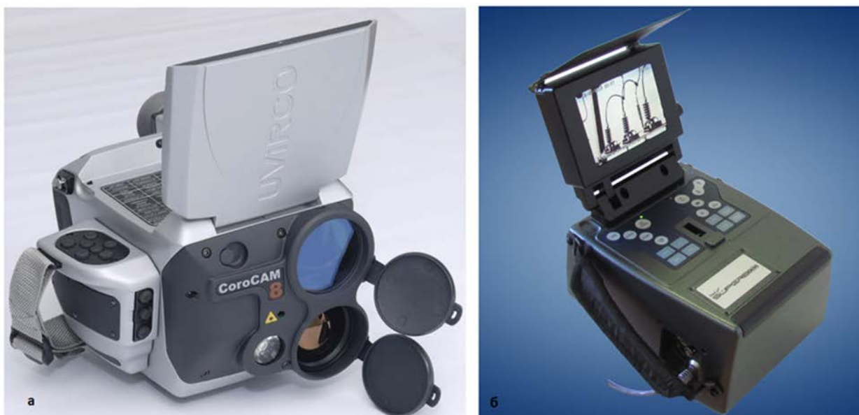
Рис. 1.7. Ультрафіолетові камери «CoroCAM 8» (а) и «DayCor Superb camera» (б)
