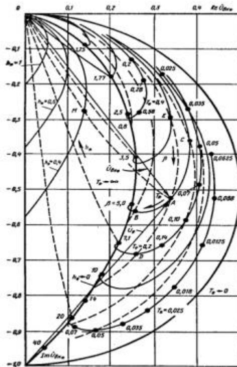
Рис. 1.19 - Годограф відносних вносимих напруг
