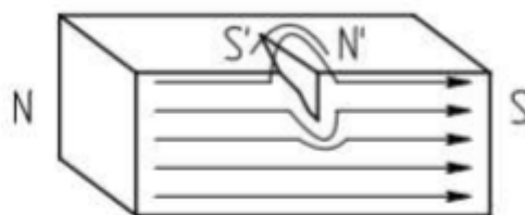
Рис. 1.2 - Магнітне поле розсіювання над тріщиною
