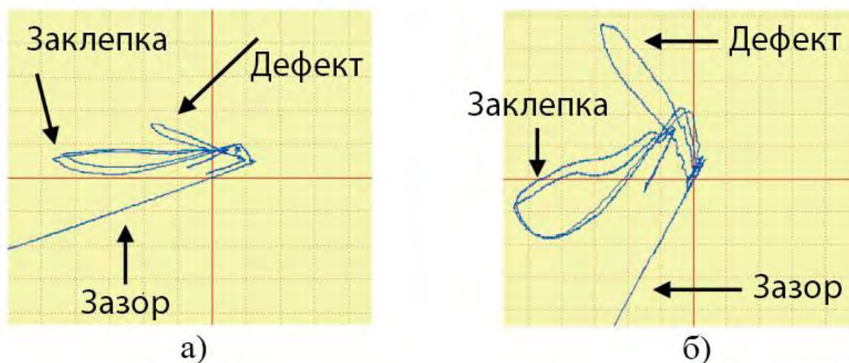
Рис 1.9. Сигнали однокатушкового перетворювача в комплексній площині орієнтованого горизонтально у вихідному вигляді (а) та після перетворення (б)
