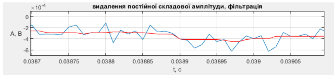
Рис 3.3. Фрагмент функції амплітудної модуляції: червоним кольором позначено сигнал після фільтрації, а синім – до фільтрації
