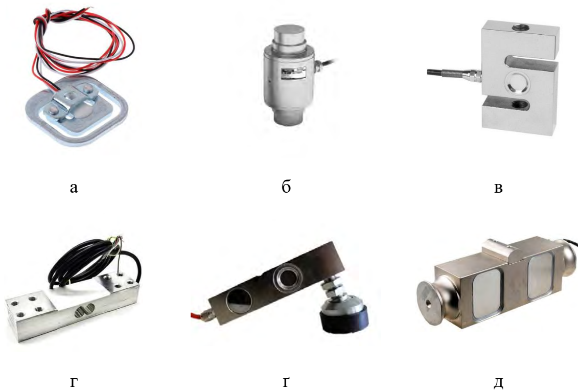
Рисунок 1.5.1 –Тензодатчики ваги різних конструкцій: а - міні-сенсор, б – колона, в - S-подібний, г - Single-point, г - балка зрізу, д - двостороння балка зрізу
