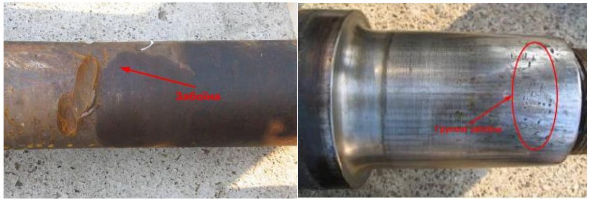
Рисунок 1.13. Забоїна на середній частині осі; групові забоїни на шийці осі.
