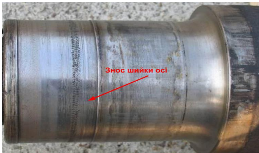
Рисунок 1.18. Знос шийки осі через прокручування внутрішнього кільця
