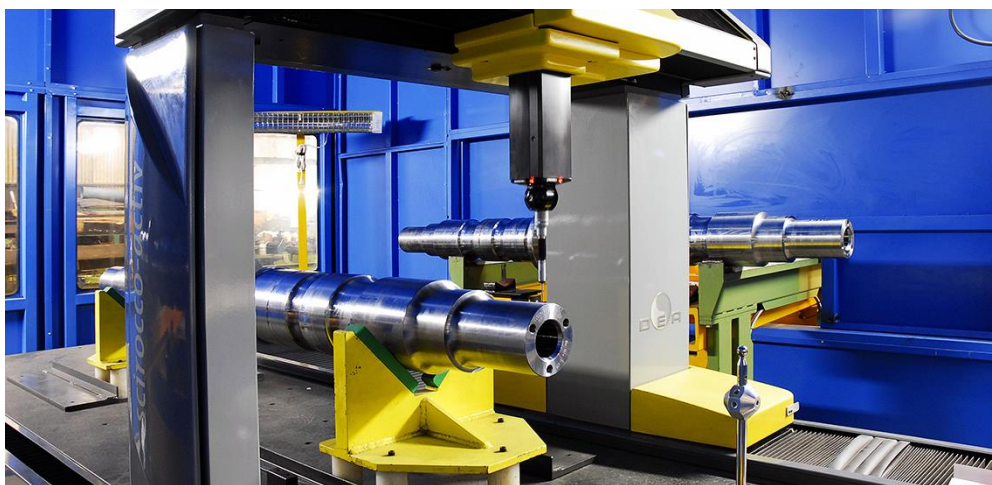
Рисунок 1.3. Обробка порожнистої осі
