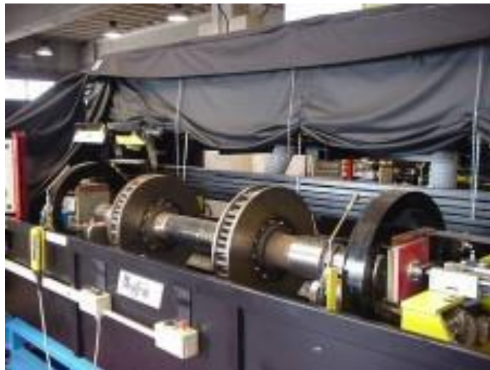
Рисунок 1.23. Контроль вагонної осі магнітопорошковим методом.
