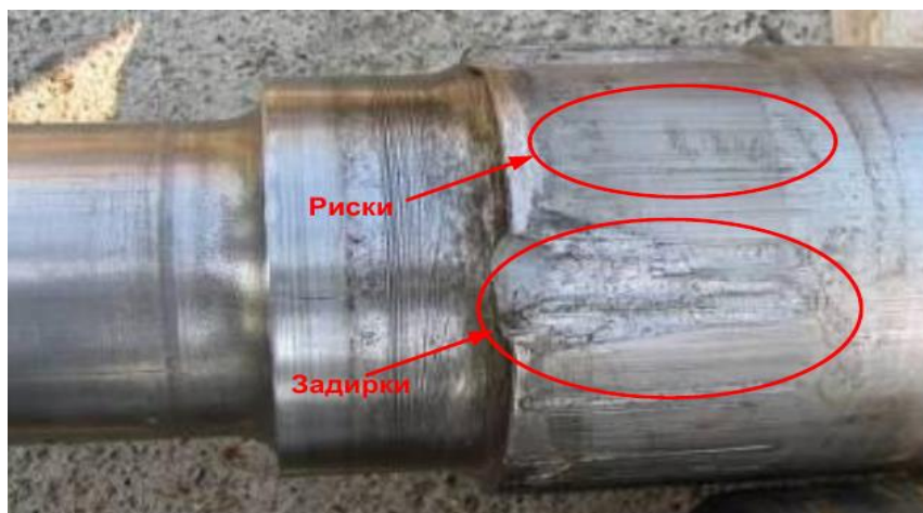
Рисунок 1.15. Риски і задирки на підматочинній частині осі.
