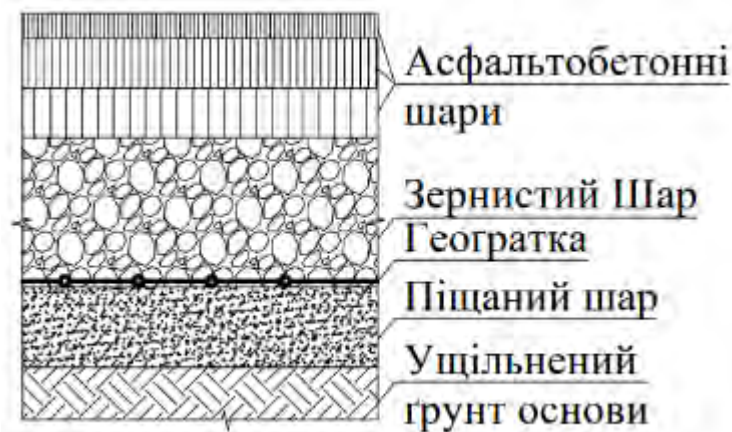
Рис.1.1.2: Поперечний переріз структури дорожнього покриття
