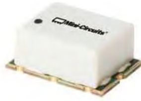
Рис. 3.5. Зовнішній вигляд фазового детектора SYPD-1+
