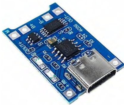
Рис. 3.8. Зовнішній вигляд плати зарядки TP4056
