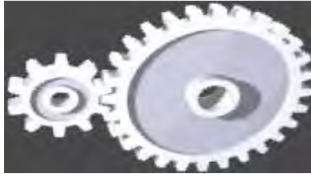
Рис. 2.4. Показано циліндричну зубчасту передачу, підберемо кількість зубців:
