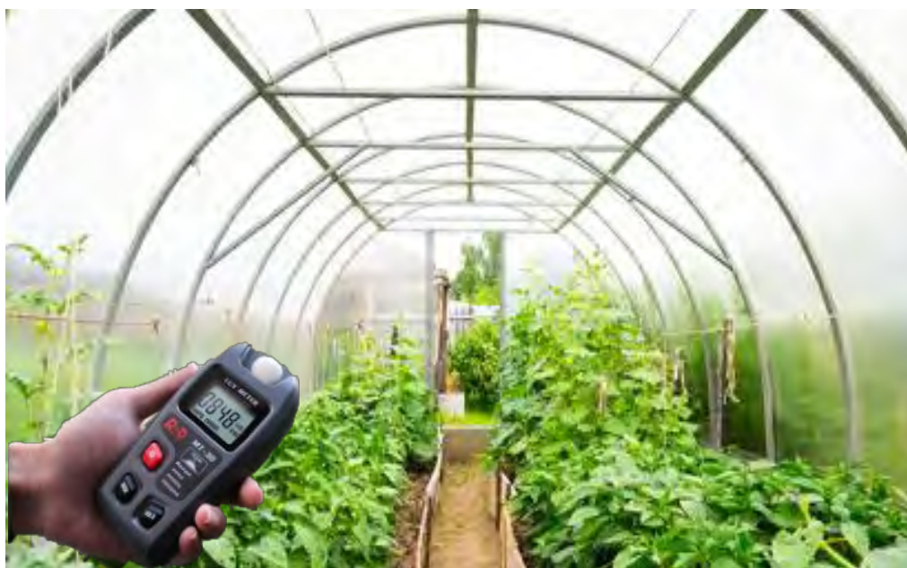
Рисунок 1.7 Використання люксометра в теплиці
