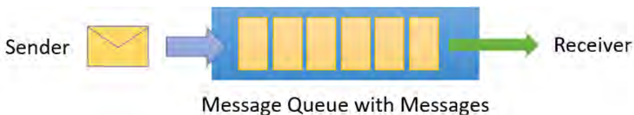
Рисунок 3.4 Схема роботи брокерів повідомлень
