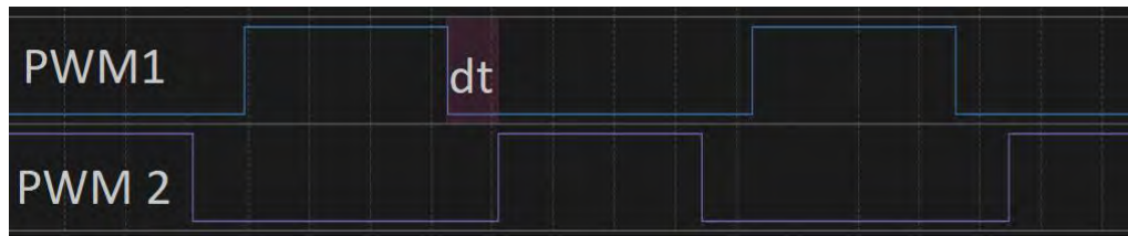
Рис. 1.3 – Сигнали керування затворами транзисторів у дискретному синхронному понижуючому перетворювачі напруги.
