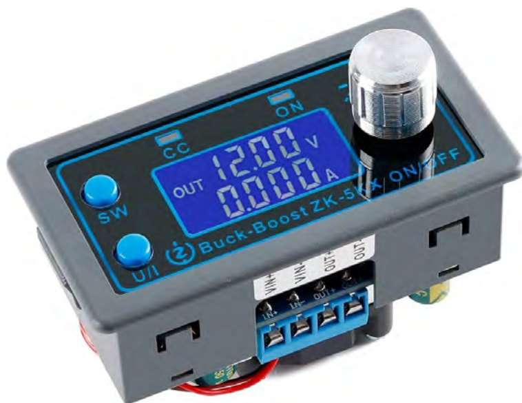
Рис. 3.3 - Цифровий понижуючо-підвищуючий перетворювач постійної напруги зі стабілізацією сили струму.
