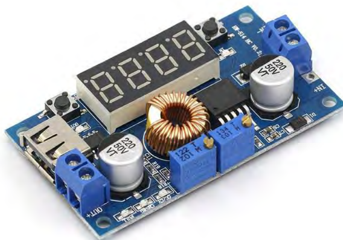
Рис. 3.4 - Аналоговий понижуючий перетворювач постійної напруги з інтегральною мікросхемою.
