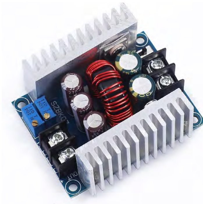
Рис. 3.2 – Аналоговий синхронний понижуючий перетворювач постійної напруги зі стабілізацією сили струму.
