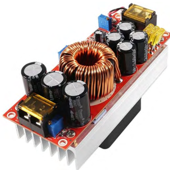
Рис. 3.1 – Аналоговий асинхронний підвищуючий перетворювач постійної напруги зі стабілізацією сили струму.
