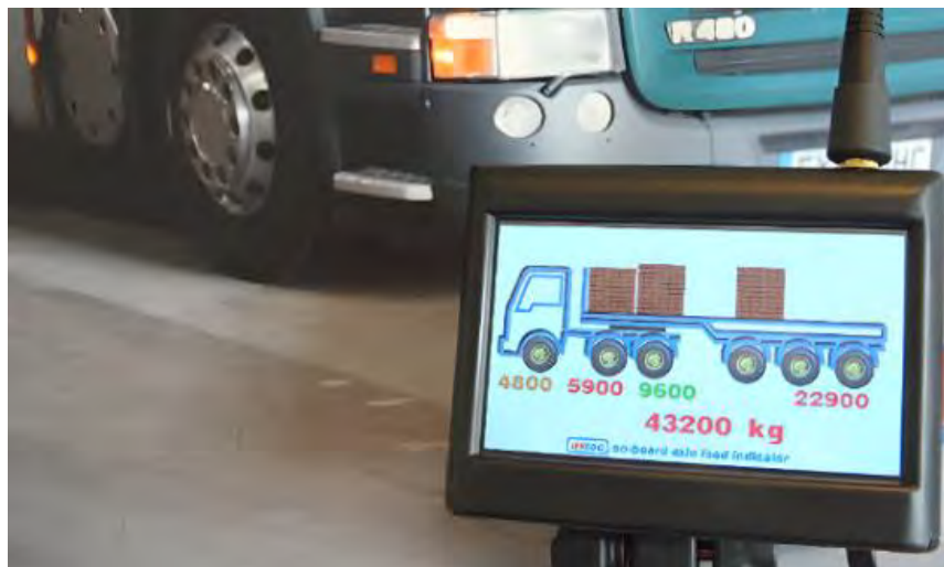
Рис. 1.21 - Статичне бортове зважування [16]
