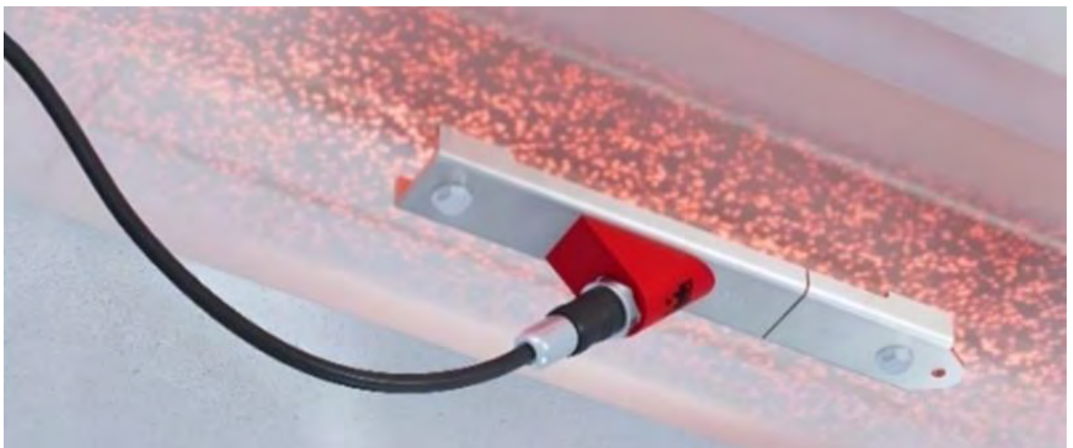
Рис. 1.20 - Встановлення датчика В-WIM [22]
