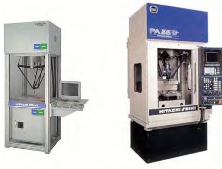
Рис. 1.7. Дельта-роботи від Hitachi Seiki для комплектації та свердління [13]
