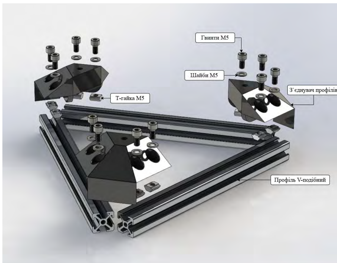
Рис. 4.1. Зовнішній вигляд рами верхньої основи
