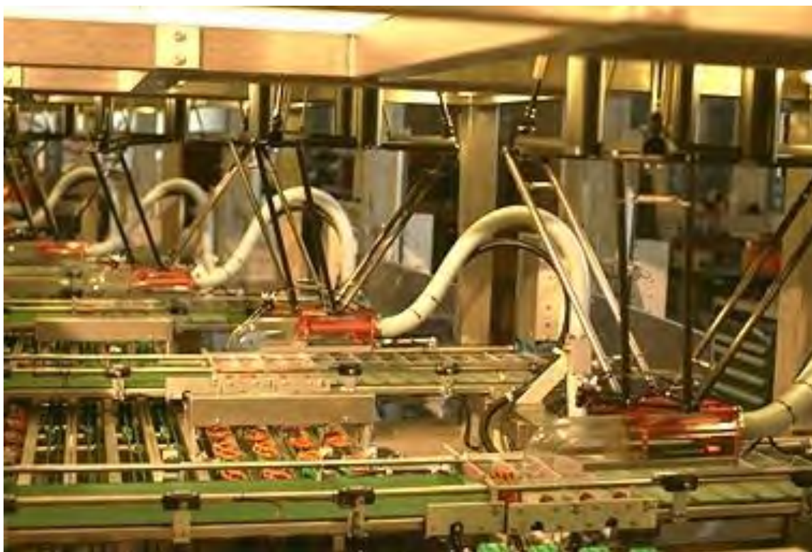
Рис. 1.5. Установка Line-Placer від Demaugex для пакування кренделів в промисловій пекарні [13]
