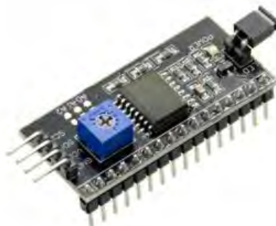
Рис 4.5 - Модуль і2с для LCD 1602 Arduino
