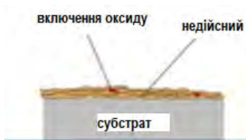
Рис 1.13 - Схематична мікроструктура термічного розпилення покриття, що показує лише кілька шарів частинок
