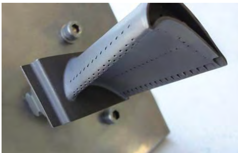
Рис. 1.6 – Приклад лопаті з отворами
