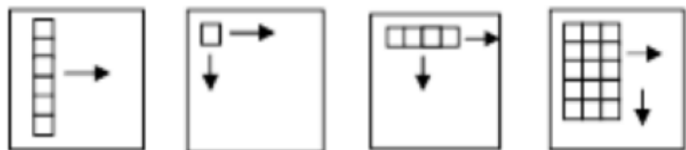
Рис.1.8.Методи сканування. Паралельне сканування, послідовно-одноелементне, послідовно-лінійне, послідовно-паралельне.
