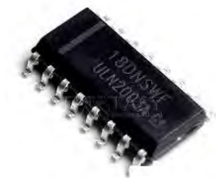
Рис. 5.2.5. Транзисторна збірка Дарлінгтона ULN2003а
