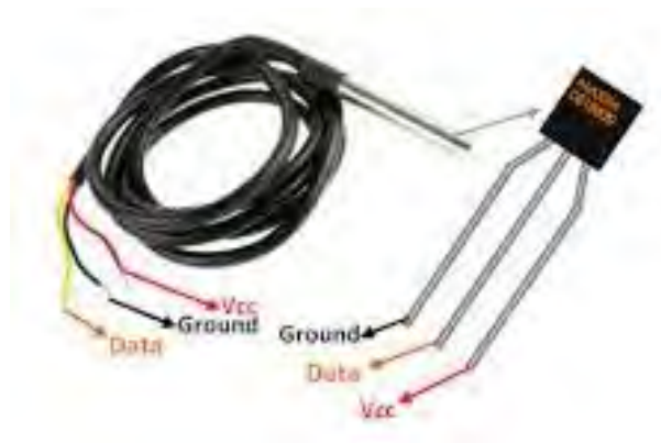
Рис. 4.3.1. Датчик температури DS18B20
