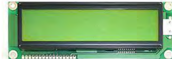
Рис. 5.2.1. Зовнішній вигляд індикатора SC1602AULT-XH-HS-G
