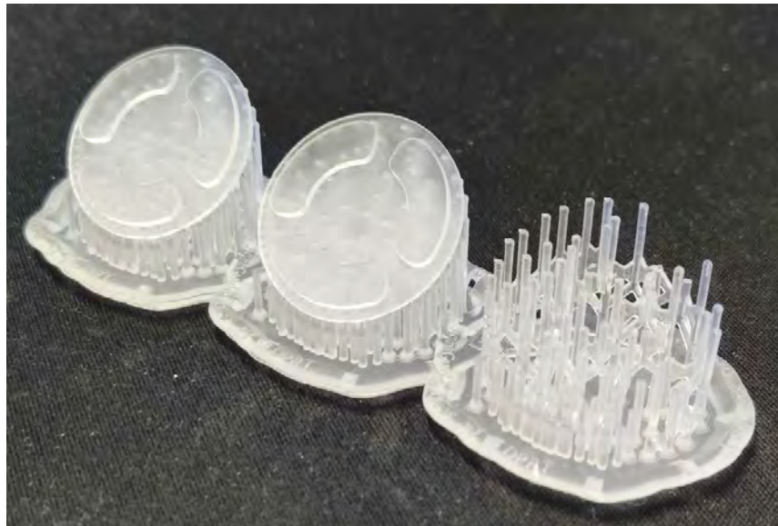
Рис. 41. Світловоди-розсіювачі виготовлені SLA технологією друку
