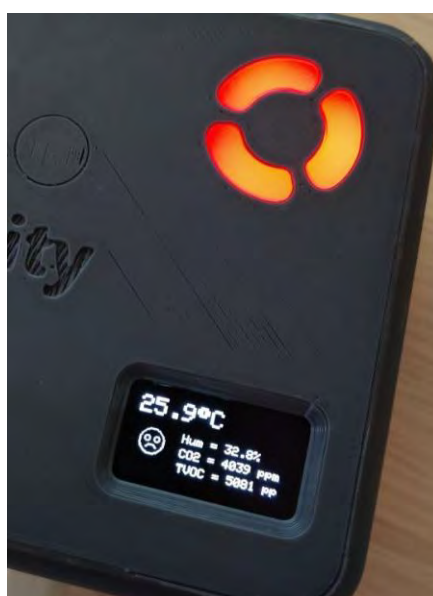
Рис. 24. Реакція монітору системи на пари спирту
