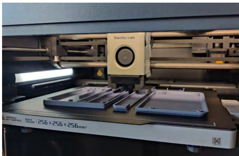
Рис. 38. Процес виготовлення деталей для хабу системи
