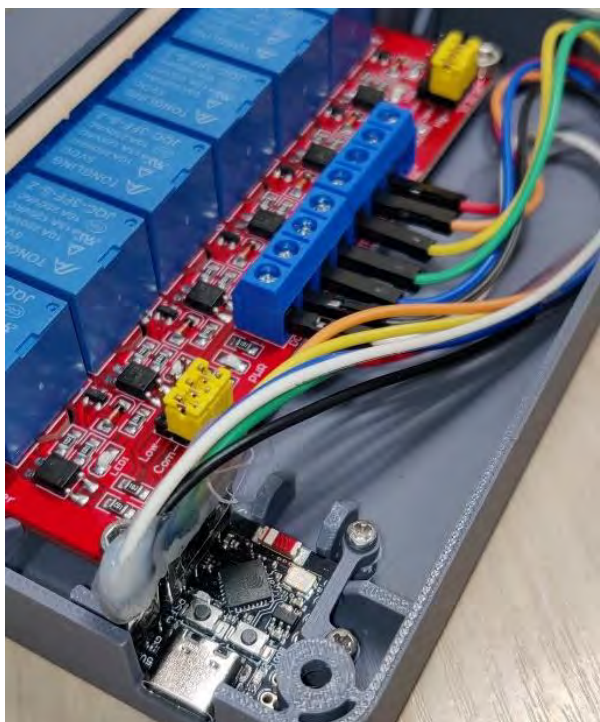
Рис. 20. Макет хабу керування мікрокліматом
