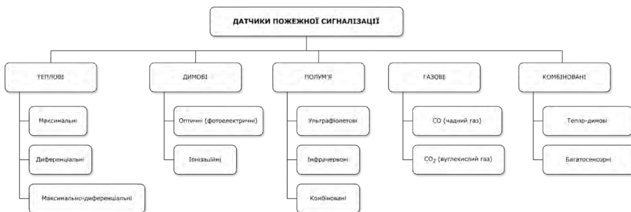
Рис. 1.1 Класифікація датчиків пожежної сигналізації за принципом детекції
