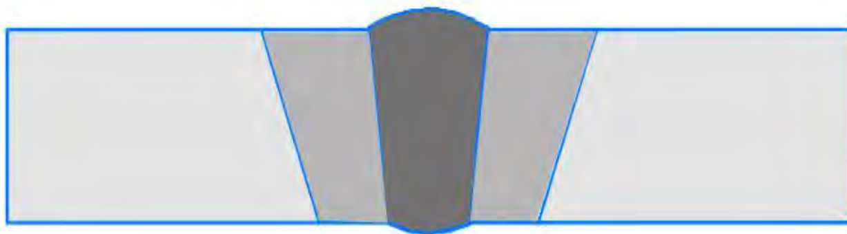
Рисунок 1.1 - Зони зварного з'єднання: основний матеріал – світло-сірий, зона термічного впливу – сірий, матеріал зварного шву – темно-сірий
