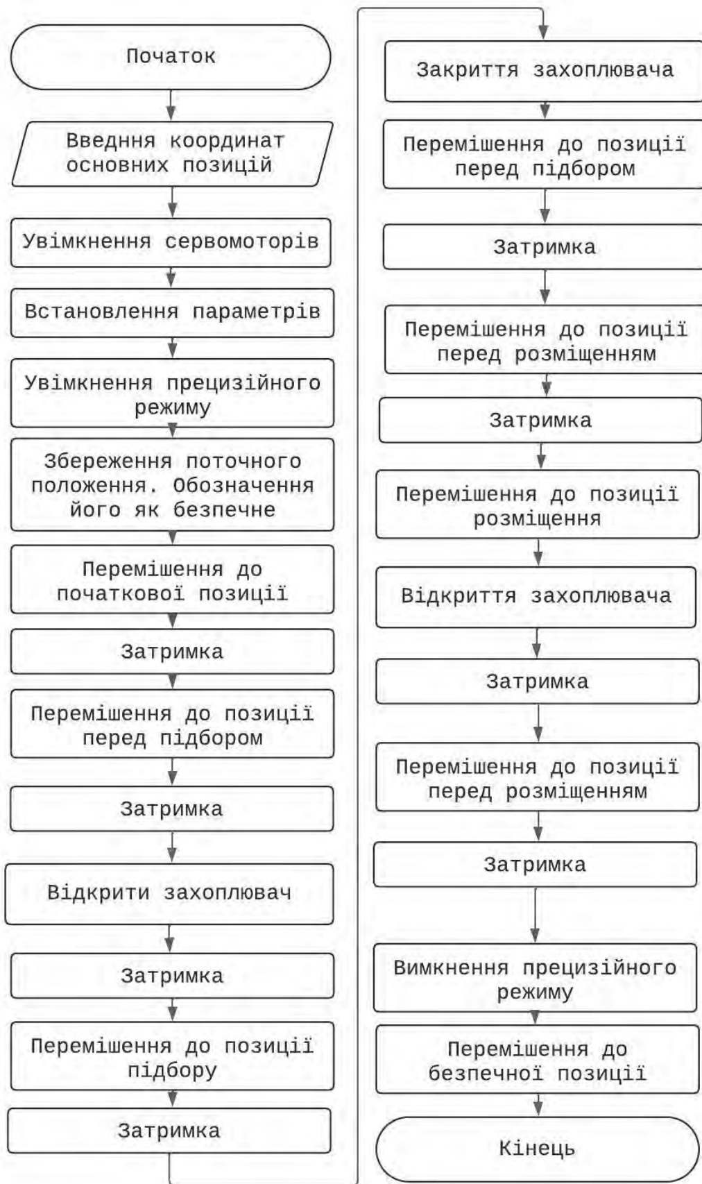
Рисунок 3.19 – Блок-схема роботи маніпулятора
