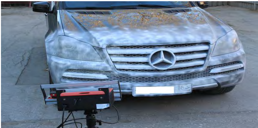
Рис. 13 Частина автомобіля попередньо покрита спеціальним спреєм
