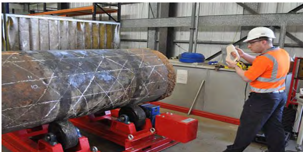
Рис. 6 Проведення контролю за допомогою Artec Eva
