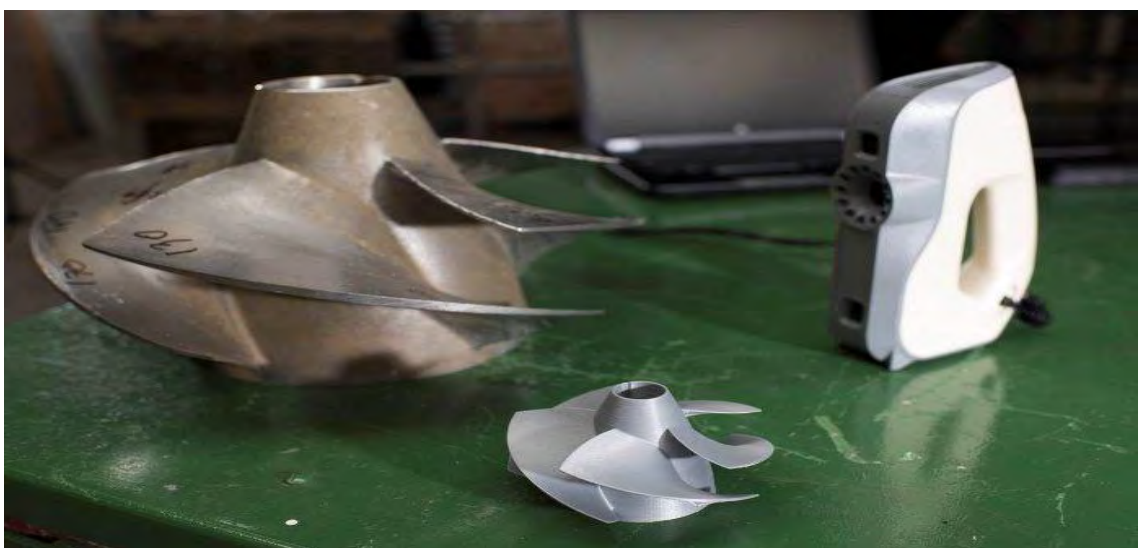
Рис. 12 Копія зламананої деталі
