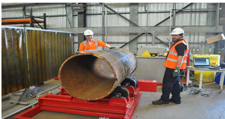
Рис. 5 Вирізаний шмат труби для проведення контролю
