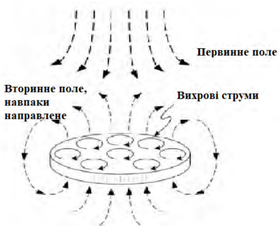
Малюнок 2.1. Механізм генерації вторинного магнітного поля для неферомагнітного предмета
