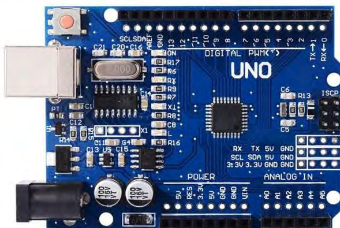
Рис. 3.4. Мікроконтролер Arduino UNO
