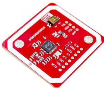
Рисунок 3.3 – Загальний вигляд модуля Elechouse PN532 NFC Module V3
