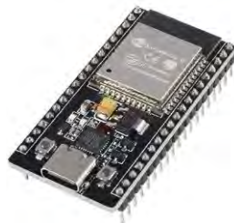
Рисунок 3.1 – Загальний вигляд плати розробника ESP32 NODEMCU-32S
