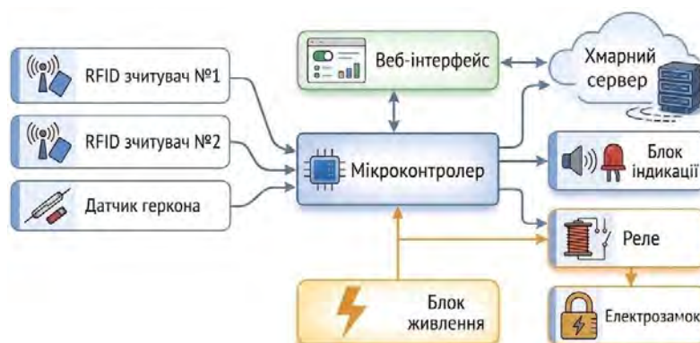
Рисунок 1.5 – Структурна схема автоматизованого пристрою контролю доступу до приміщень
